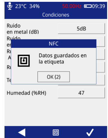
El UTP2 emitirá un pitido para indicar que se ha detectado un tag, seguido de dos pitidos para indicar que la escritura del tag se ha realizado correctamente
